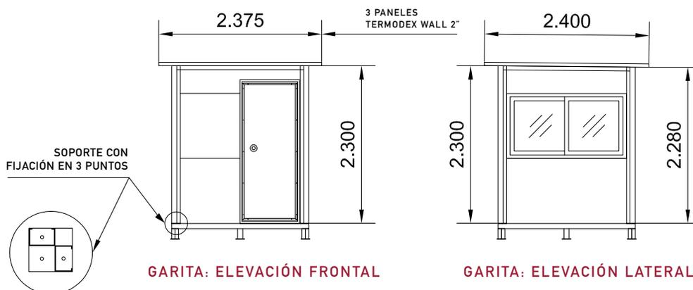
PERFORACIONES DE Ø 7/16" Y FIJACIÓN CON TUERCAS Ø 3/8"X1" + ARANDELA
